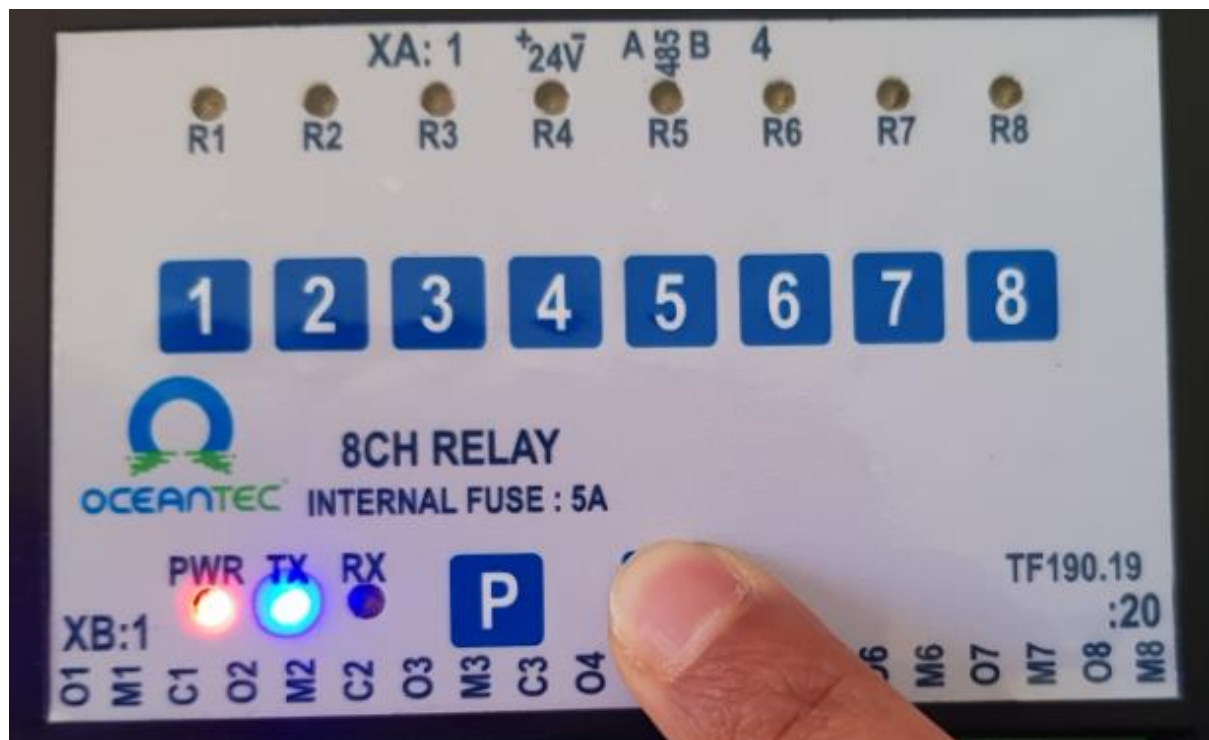
روشن ماندن LED آبی به هنگام Release کردن کانال ها
