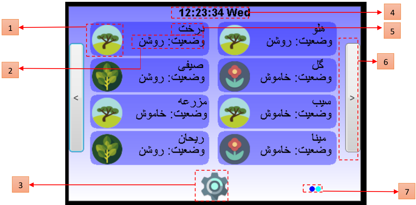
پایش ۸ نوع گیاه مختلف با نام های متفاوت و نمایش وضعیت خروجی هر کانال
